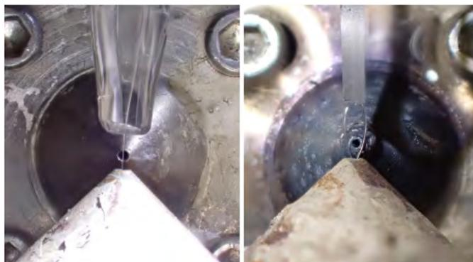
**Figure 1. a.** Deux types de jet liquide utilisés couramment sur la ligne PLEIADES (synchrotron SOLEIL) pour les études de photoémission sur les liquides. À gauche : un jet cylindrique (40 $\mu$ m de diamètre), à droite un jet plat (épaisseur de moins de 1 $\mu$ m).
